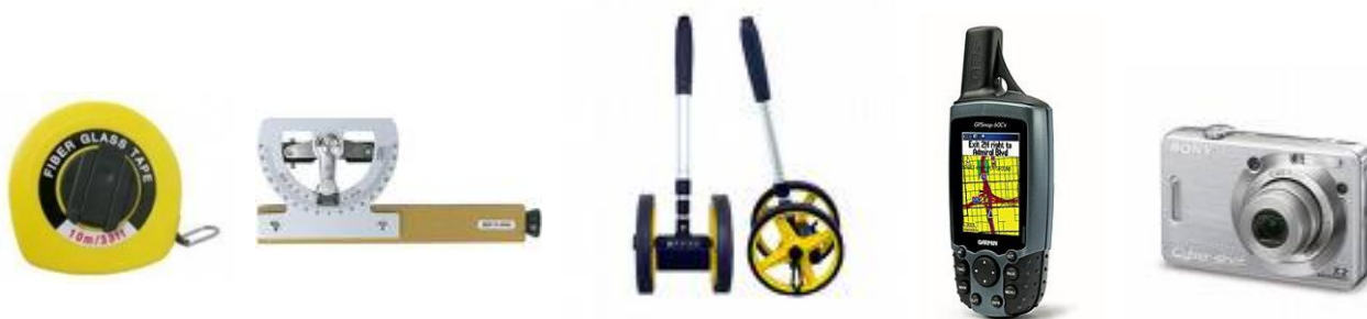
Figura 8. Equipos empleados en la toma de información de campo en orden de derecha a izquierda: Decámetro, nivel abney, odómetro, GPS con altímetro y cámara fotográfica.
